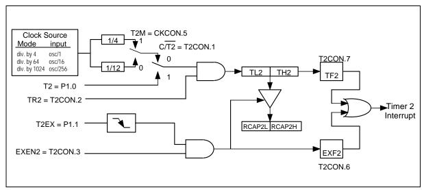
Figure 14. 16-Bit Capture Mode
